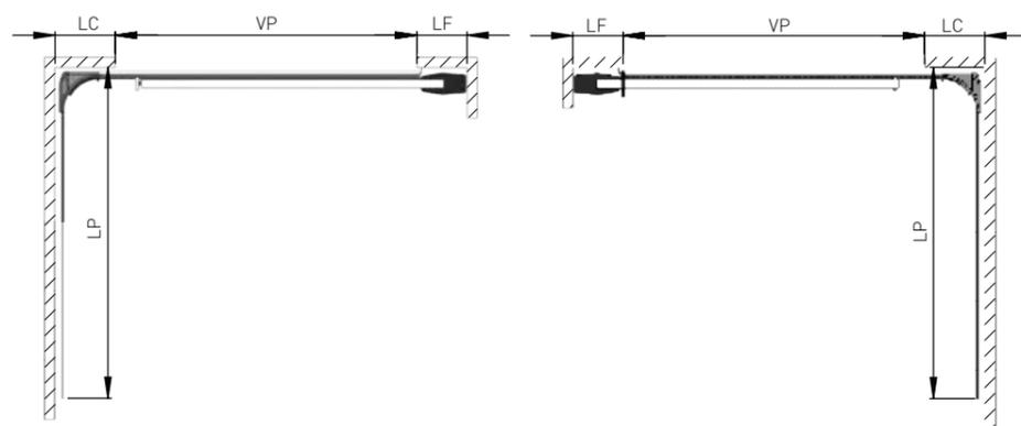
**LEGENDA |** LC - Lateral lado curva • LF - Lateral fecho • VP - Vão porta • DM - Medida da parede com motor • DP - Medida da parede p/porta manual • P - Padieira
